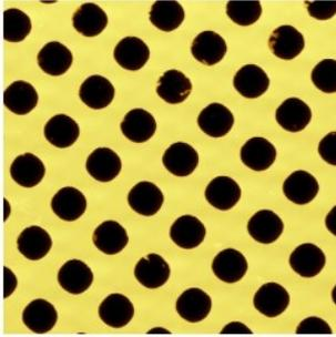
微米光栅/扫描范围  $30\mu\text{m}\times 30\mu\text{m}$
