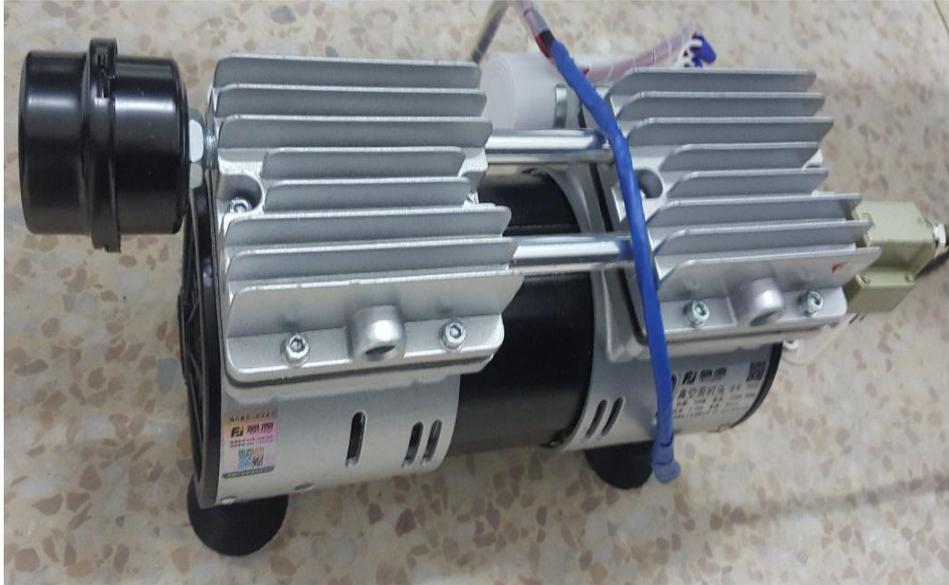
图 4 真空泵示意图
